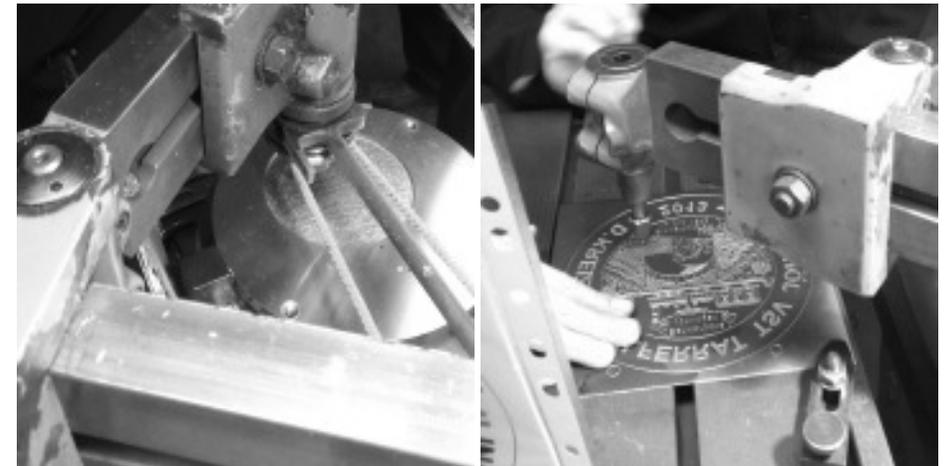
Der Entwurf auf dem Rechner muss erst mal so verändert werden, dass man ihn nachher technisch umsetzen kann. Dann werden die Konturen des Ordens auf eine Platte geätzt, danach erst grob die Tiefen gefräst und dann zum Schluss die Feinheiten. Alles wie gesagt per Hand.
